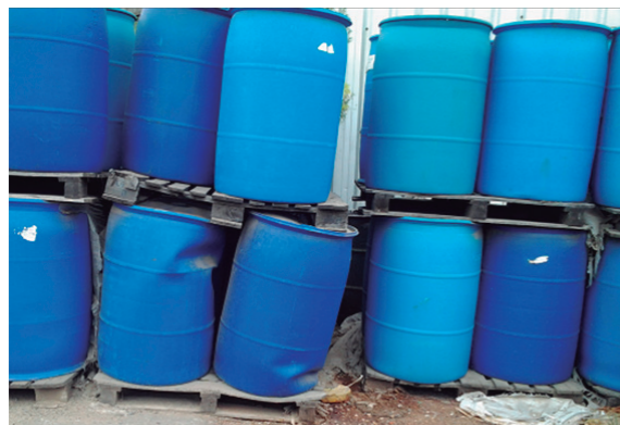
Contenedores en mal estado; acopio sobre suelo natural. Fuente: DRP.
